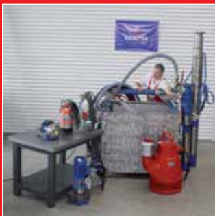
Probelauf am Pumpenprüfstand
